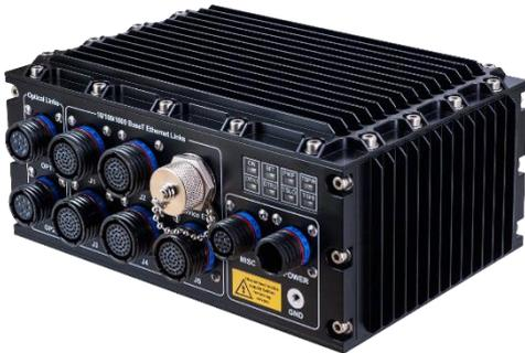
Router/Switch gestionado, ruggedizado de alta disponibilidad, con 20 puertos cobre 1Gb y 4 puertos fibra hasta 10 GbE. Se trata de un COTS potente, abierto y flexible con capacidades “Edge-Computing” gracias a sus procesadores multicore CPU, GPU y FPGA Ultrascale. Su arquitectura reconfigurable permite tecnologías HSR y PRP para asegurar el 100% de la transmisión de datos sin interrupciones ni retrasos en la entrega de paquetes incluso cuando hay fallos de red. Cuenta con TSN para una
