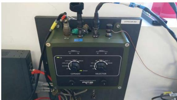
Los días 3 y 4 de diciembre CCN-PYTEC apoyo al ET en la ejecución de las **pruebas de aceptación relativas al cifrado de voz y datos por la Red Radio de Combate**, a través de la última versión del Gestor de Comunicaciones de ET (**GESCOMETv4S**) y de la nueva Unidad de Comunicaciones Seguras (**UCS**). Estos dos productos desarrollados por RF Española integran las soluciones de cifra TZ-1001R y TZ-501R (familia CIFPECOM) de Tecnobit.
