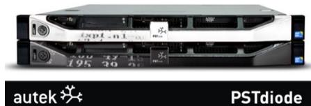
El diodo de datos hardware PSTdiode es un dispositivo de protección de perímetro que permite la transferencia de información en un único sentido entre dos dominios de seguridad con garantía física de transmisión unidireccional. Su aplicación principal es la introducción de información en una red aislada en entornos clasificados. También se puede aplicar para extraer información de una red de control industrial en entornos de infraestructuras críticas.
